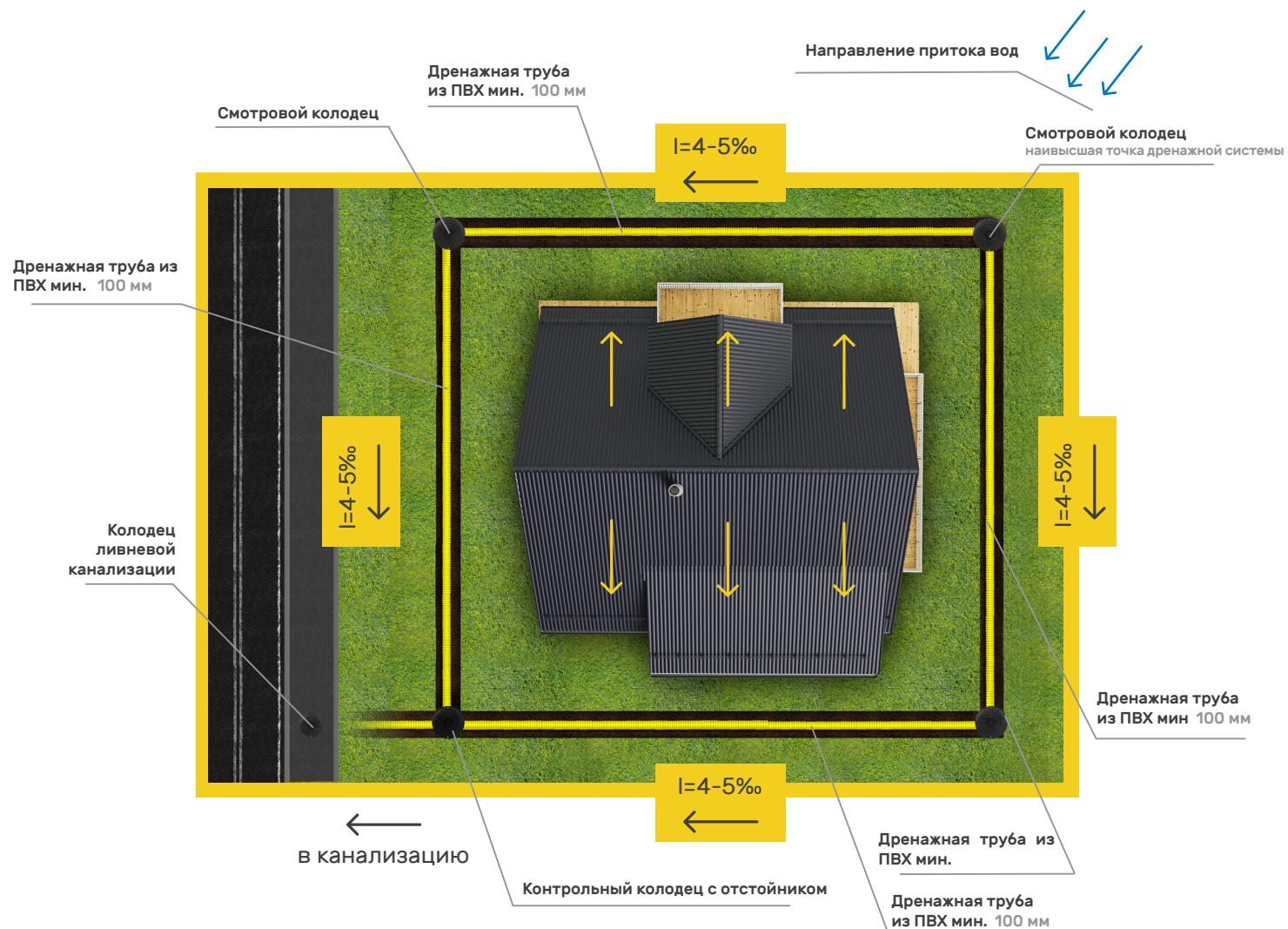
Очень важно выполнить дренаж, если дом расположен на склоне, откосе или рядом с ним. Вода, которая стекает по склону, задерживается у фундамента. Это приводит к размягчению грунта, что, в свою очередь, может стать причиной смещения стены здания. В таком случае дренаж необходимо выполнить независимо от типа основания, при этом его нужно сделать только со стороны возвышения.
